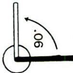
Auf der Innenseite Umstellschlüssel in das Schlüsselloch einführen bis zum Anschlag. Umstellschlüssel um 90° entgegen dem Uhrzeigersinn drehen und in dieser Stellung stecken lassen.
