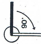
Zahlenknopf von dieser Stellung aus nach **rechts** drehen; so lange, bis sich die Zahl (8) das **dritte** Mal mit der Kennmarke deckt.
